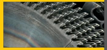
Zustand nach Reinigungsprozess mittels Ultraschallschwingers und Oberflächenströmung (ca. 20-60 Minuten ohne zusätzliche mechanische Einwirkungen (Bürsten, oder Ähnliches), Einsatz eines Zusatzstoffes mit einer Konzentration von 1 %).
